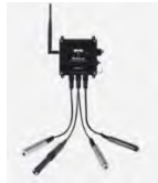
Figura 13.- Sistema de adquisición de datos de campo oxígeno disuelto, PH, conductividad, ultrasonido.
