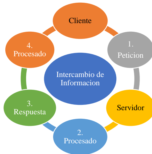
Fig. 1. Arquitectura cliente-servidor, pasos de intercambio de información Petición del Cliente (1). Procesado en servidor (2). Respuesta del servidor (3). Procesado en cliente (4).
