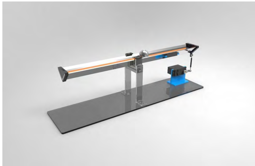
Fig. 4. Estructura del sistema barra y bola modelada en SolidWorks
