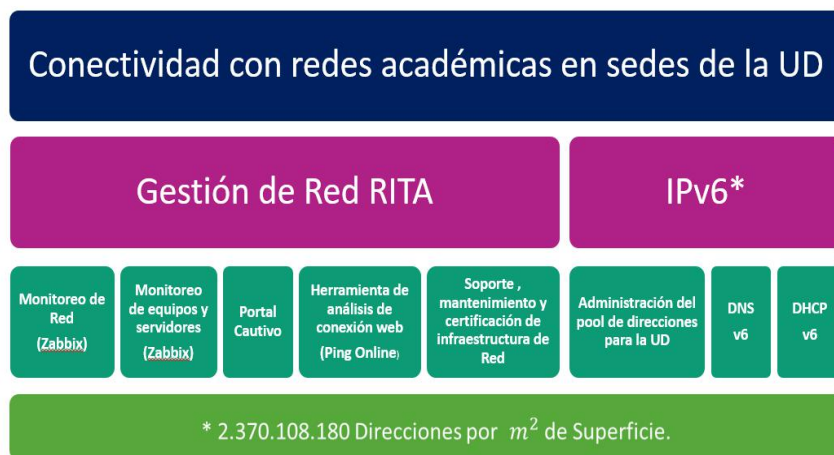
Fig. 17. Esquema de Servicios de Conectividad implementados por la Red de Investigaciones de Tecnología Avanzada - RITA.
