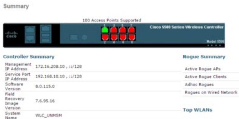
Fig 7: Direccionamiento IP y versión del software.
