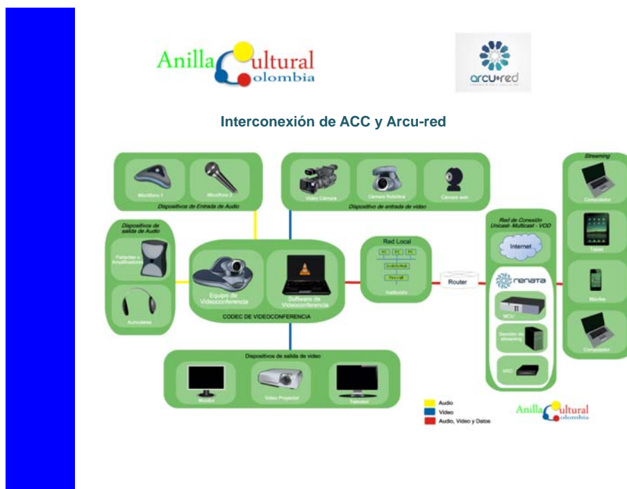
Fig. 2. Interconexión de ACC y Arcu-red
