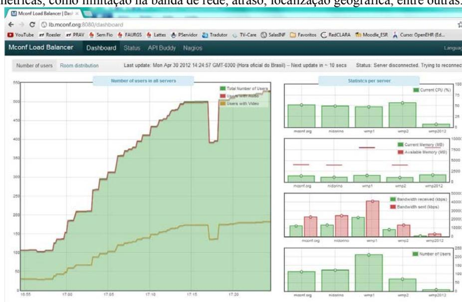
**Fig. 16.** Resultado de escalabilidade com o Mconf utilizando como métrica o balanceamento de CPU entre os diversos servidores. A figura mostra um acesso de quase 600 usuários simultaneamente no sistema, com a CPU entre os quatro servidores balanceada, atingindo pouco mais de 50%.
