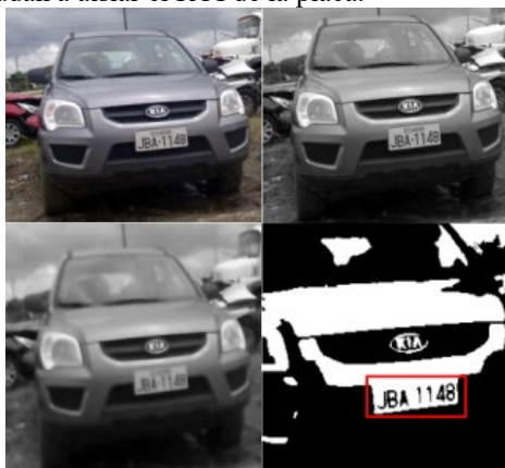
Fig. 4. Filtros aplicados a imagen para aislar ROI de la placa vehicular.
