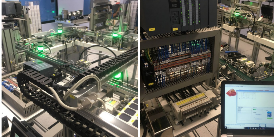
Fig. 2. Fotografías de los componentes del laboratorio donde se muestra la línea de producción (izquierda) así como las opciones de configuración del software y PLC incorporados en el laboratorio (derecha).
