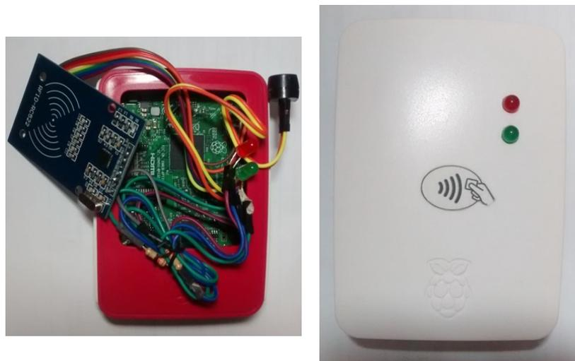
Fig. 13. Conexión física de leds y buzzer en la RaspBerry Pi (abierta y cerrada).
