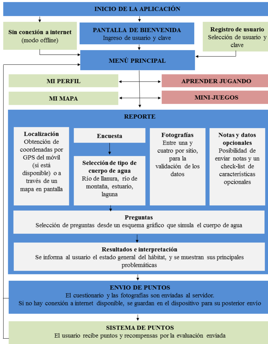
Fig. 1. Diagrama de bloques del funcionamiento de la aplicación móvil AppEAR. Los bloques en azul indican la trayectoria desde el inicio de la aplicación hasta el envío de un reporte completo. Los bloques de color rojo demarcan las características educativas de la aplicación, mientras que los de color verde indican las funciones accesorias al funcionamiento.
